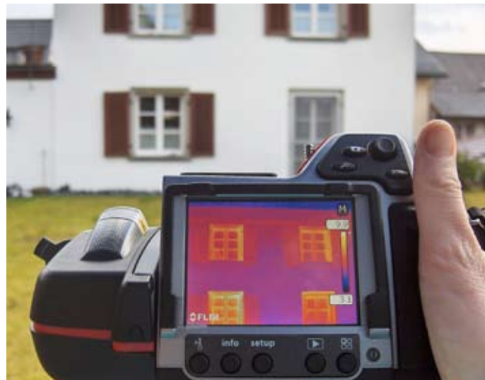
Wärmebildkamera im Einsatz.
