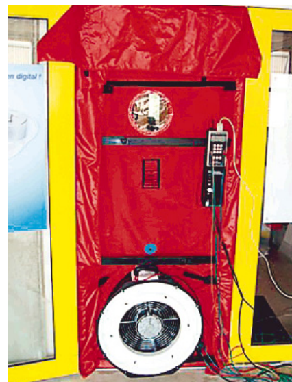
Mit der «blasenden Tür» wird Luft aus dem Haus gesaugt. So erkennt man Lücken in der Hülle. Foto: pd
